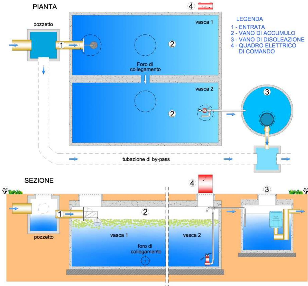
Per le superfici di grandi dimensioni il sistema **METEOTANK® MP/SD** è costituito da due o più vasche, poste in parallelo, ed aventi la predisposizione per il loro collegamento sul fondo
